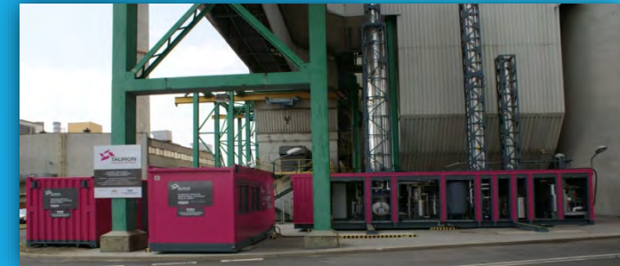
Mobile pilot plant for CO 2 separation (Tauron, Elektrownia Łaziska), 200 m 3 /h
